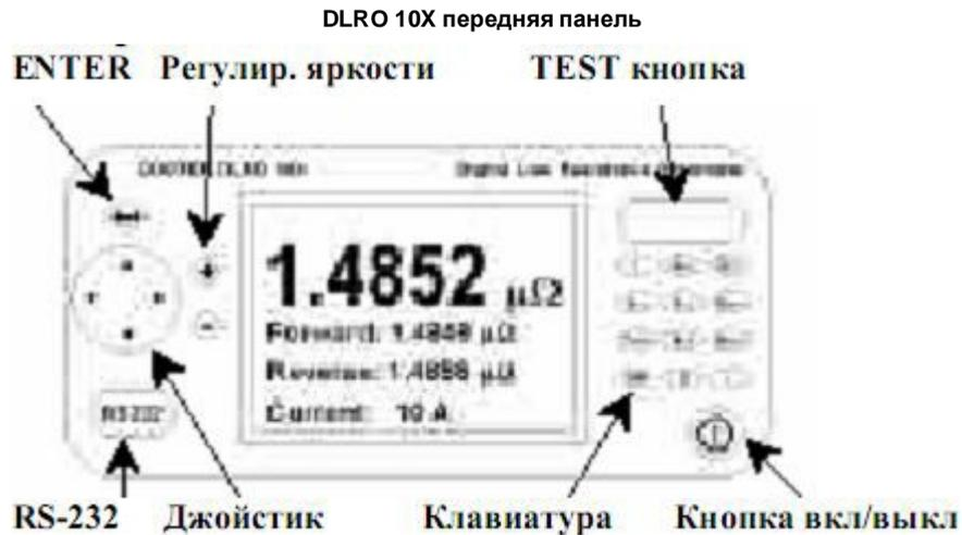
Все контролирующие органы управления, дисплей находятся на передней панели прибора.
